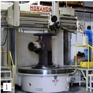
1: Cabezal de descarga de maquinado
